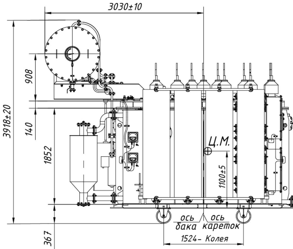
Сторона регулировочного трансформатора
