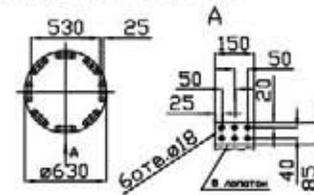
Фланец для крепления токопровода НН
